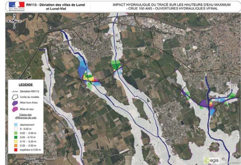
Figure 8 : Impacts sur le risque d'inondation pour une crue centennale, avec des ouvrages droits au niveau du ru de Cabanettes (source : études hydrauliques).
